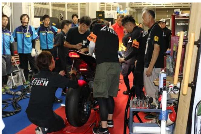
ピットインして修理作業に手間取ればチェッカーを受けることが出来ません。チームが下した決断はピットインして修理でした。自光式のゼッケンは無機 EL シートを利用しており、それを光らすためにインバーターを組み込んでいるのですが、状況からそのインバーターが故障していると判断し、ユニット交換すれば治ると確信していました。後は時間との勝負です。
